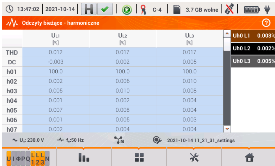
Rys. 57. Odczyty bieżące - harmoniczne - widok tabelaryczny.
