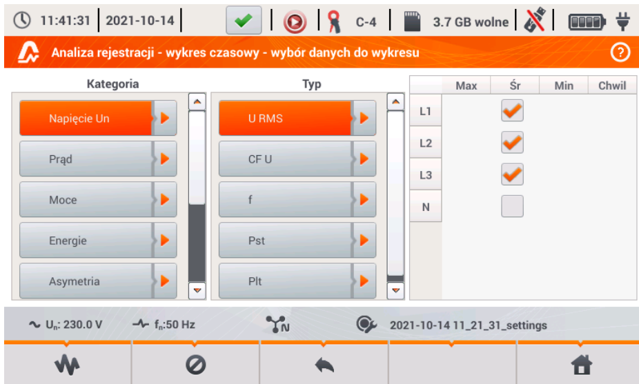
Rys. 24. Analiza rejestracji - wybór parametrów do wykresu czasowego.
