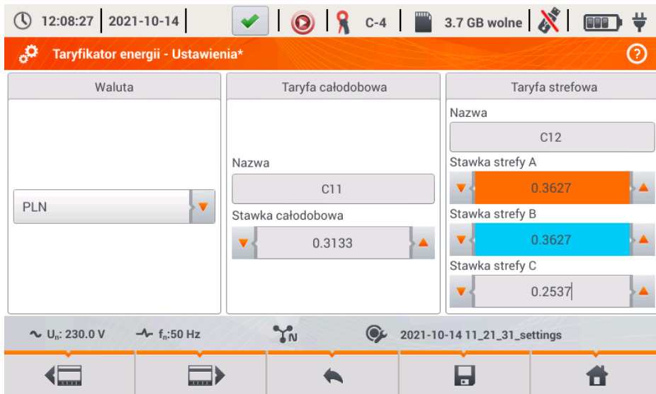
Rys. 34. Taryfikacja energii – Ustawienia główne.
