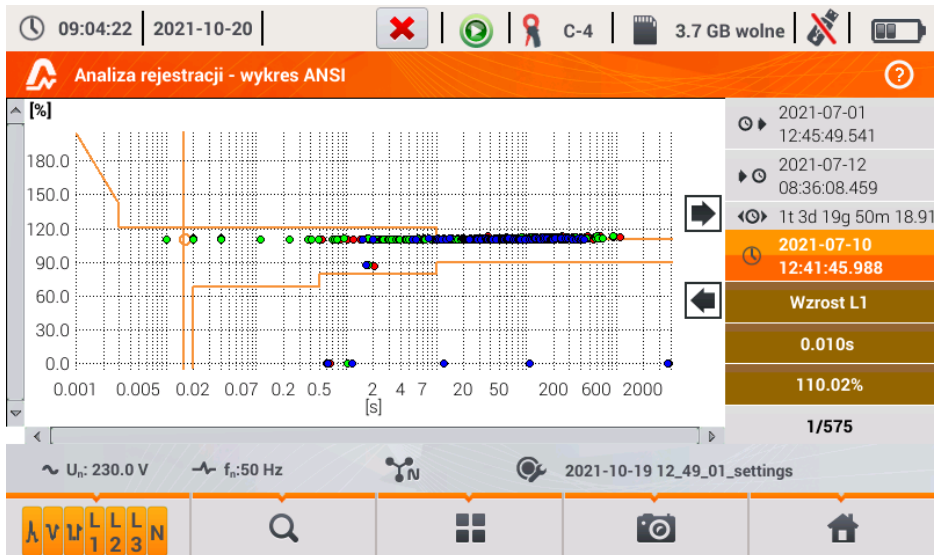
Rys. 31. Analiza rejestracji - wykres ANSI.
