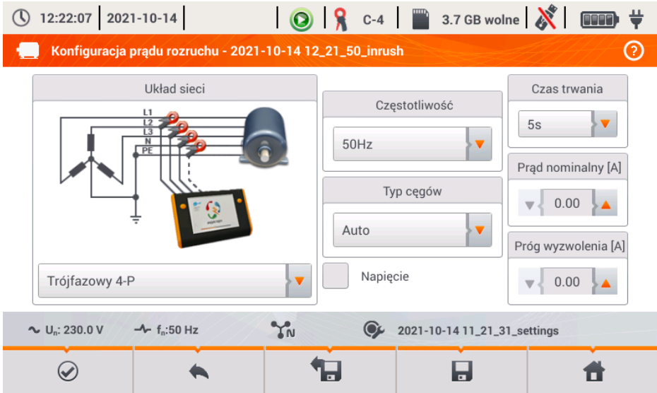
Rys. 39. Ekran ustawień prądu rozruchu.
