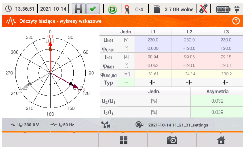
Rys. 55. Odczyty bieżące - wykres wskazowy.
