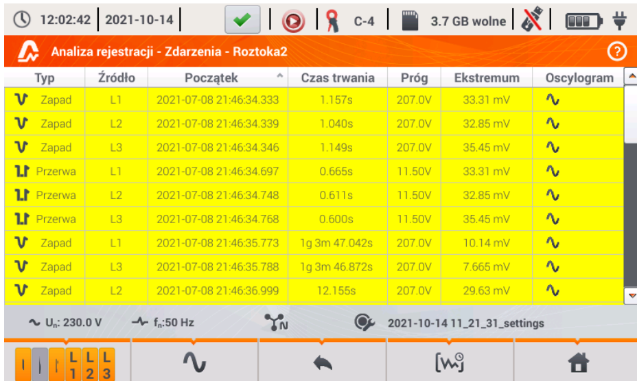
Rys. 29. Analiza rejestracji – lista zdarzeń.
