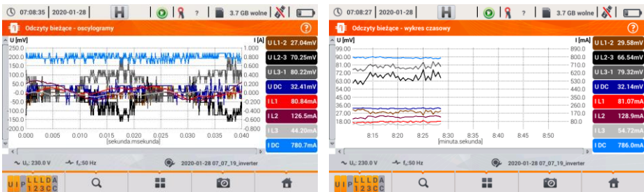
Rys. 48. Ekran oscylogramów i wykresów czasowych w trybie pomiaru sprawności inwertera.
