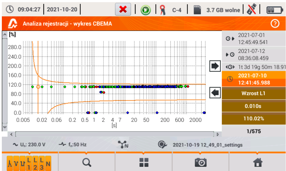
Rys. 32. Analiza rejestracji - wykres CBEMA.
