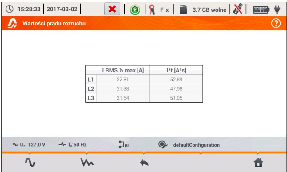
Rys. 44. Prąd rozruchu – parametry charakterystyczne.
